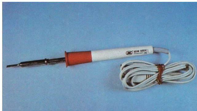
Forma habitual de un soldador eléctrico, recto del tipo lápiz, de media potencia.
