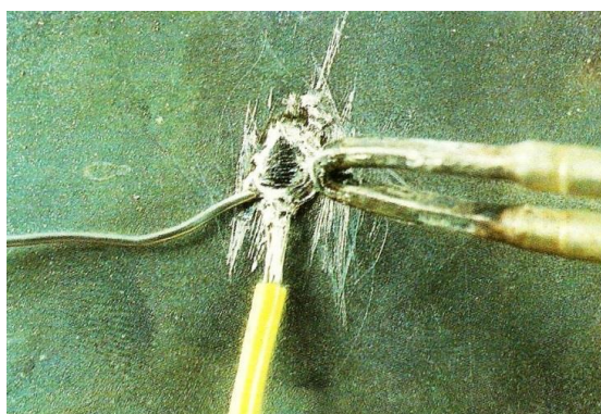
Después se aproxima el terminal al punto de soldadura, calentando el conjunto con el soldador y aportando una cierta cantidad de estaño.
