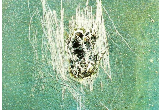
Soldadura en un punto de una superficie grande, empleando un soldador de pistola. Después de limpiar la zona se realiza un estañado previo.
